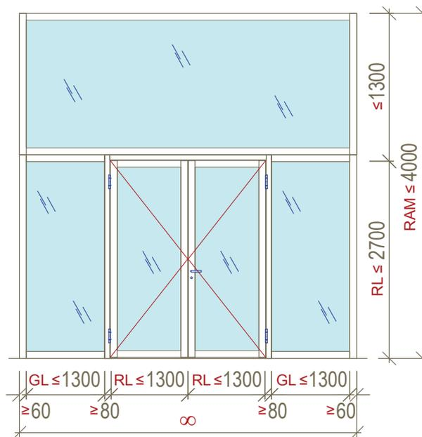
**Legende**      RAM = Rahmenausmass      RL = Rahmenlicht      GL = Glaslicht
